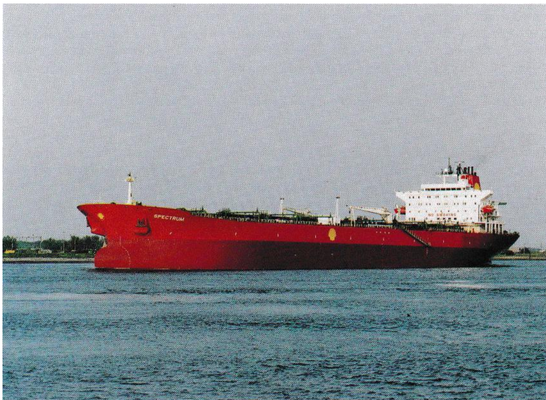
De hedendaagse tanker is wel even groter dan die van voor de oorlog. Deze Shell-tanker, de “Spectrum”, dateert van 1985 en heeft afmetingen van 244 x 42 x 20 meter. De bruto tonnage is 56.456 ton en netto 32.733.
